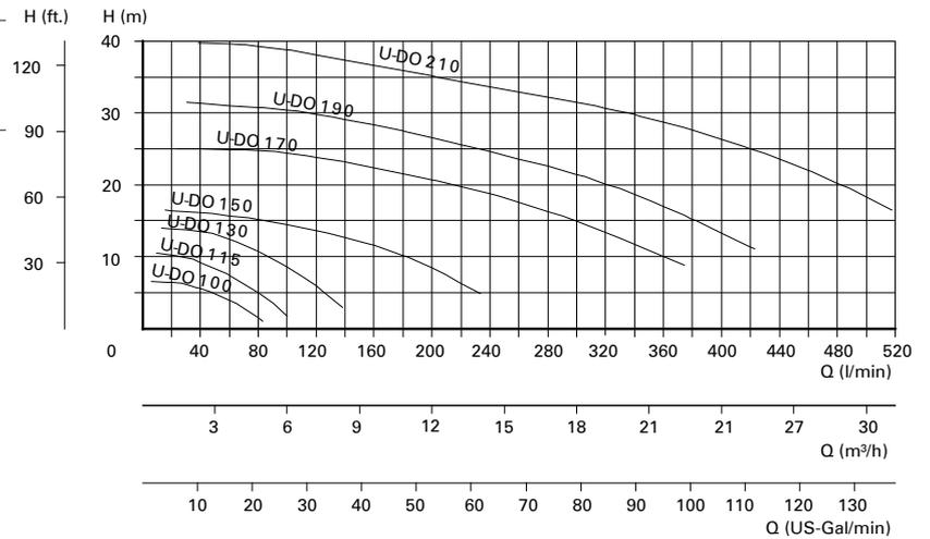
Kennlinien mit Wasser bei 20°C und 2900 U/min (50 Hz.) gemessen.
